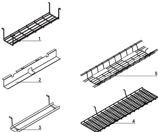
1. **Schiene S69** - Metall, pulverbeschichtet, Aluminium - 09
